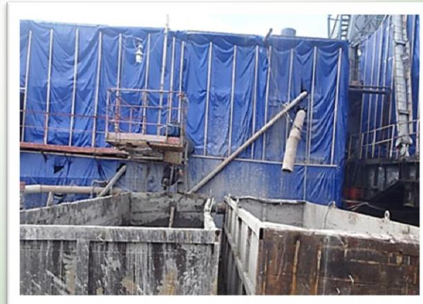
Прием буровых отходов осуществляется в емкости, вмещающий объемом – 40 м<sup>3</sup>. На площадке производится установка нескольких (двух и более) приемных емкостей обеспечивающие раздельное накопление различных фаз буровых отходов (жидких и твердых (пастообразных)).
