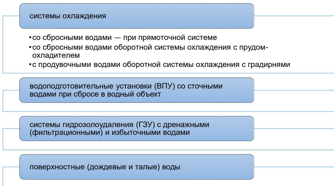
Рисунок 1.2 — Сбросы сточных вод, подлежащие нормированию и контролю на ТЭС.
