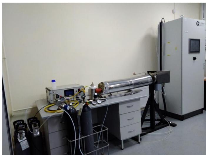
Рисунок 3.5 — Общий вид вторичного эталона для проведения испытаний систем автоматического контроля выбросов (без системы подготовки воздуха)
