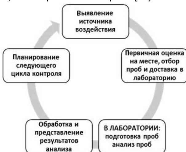
Рисунок 3.1 — Типовой цикл ПЭК при использовании классического пробоотбора.
