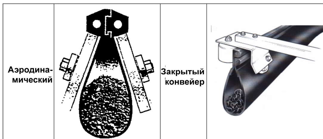
Рисунок 31 – Примеры подвесных ленточных конвейеров
