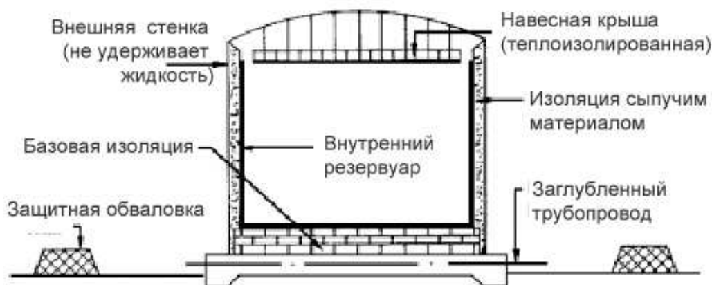
Рисунок 9 – Резервуар с одинарной стенкой
