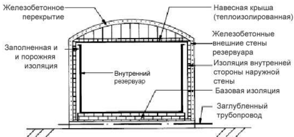
Рисунок 11 – Резервуар с полной защитной оболочкой
