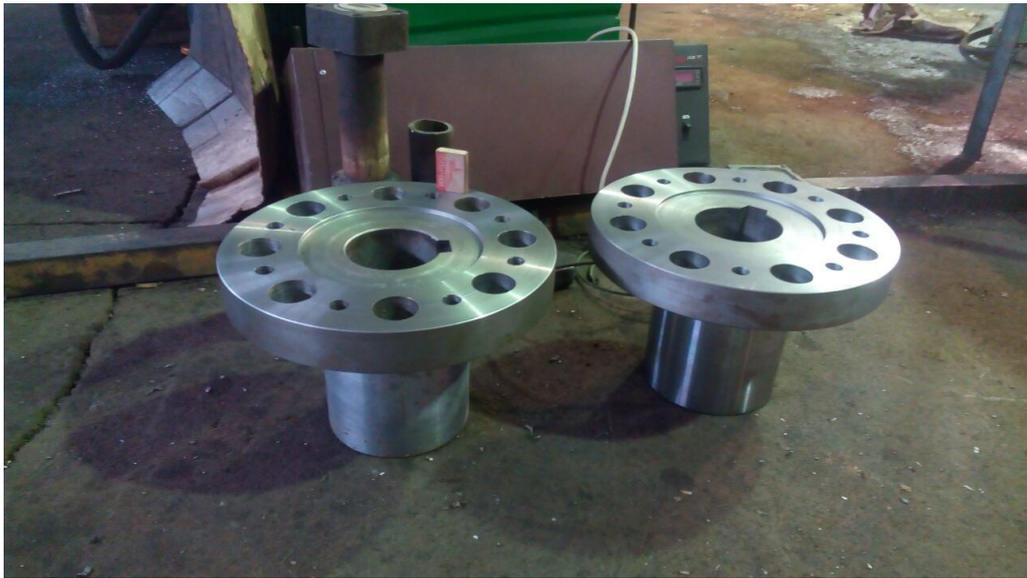
Муфта предназначена для передачи крутящего момента от вала редуктора к валу разрывной машины. Полумуфты на 16 сайлентблоках. Данная конструкция значительно увеличивает надежность соединения. Упрощается монтаж. Больше не нужно каждый день протягивать болты.
