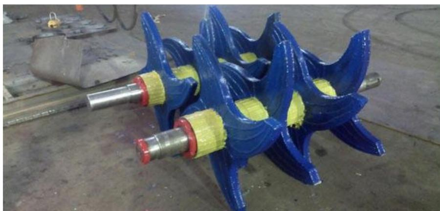
Разрывные ножи, пережили серьезные изменения в конструкции и технологии изготовления. Новая геометрия ножей, за счет чего получилось добиться уменьшения нагрузки на нож, а так же намотку стружки на вал и увеличить производительность.
