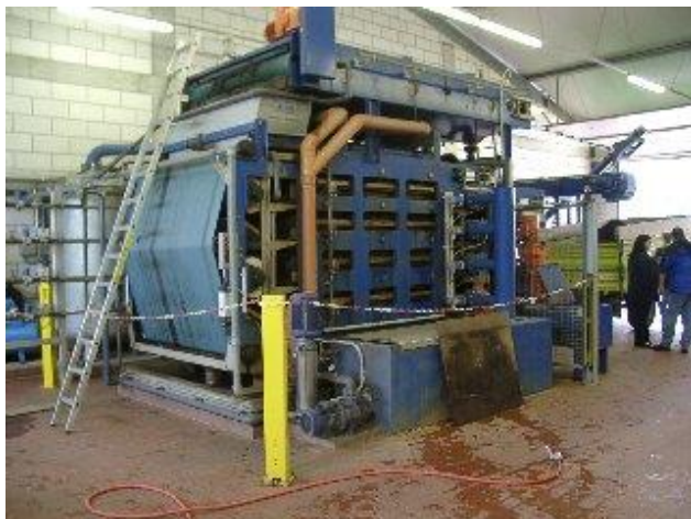
Цех мехобезвоживания с ленточным прессом (Германия)
