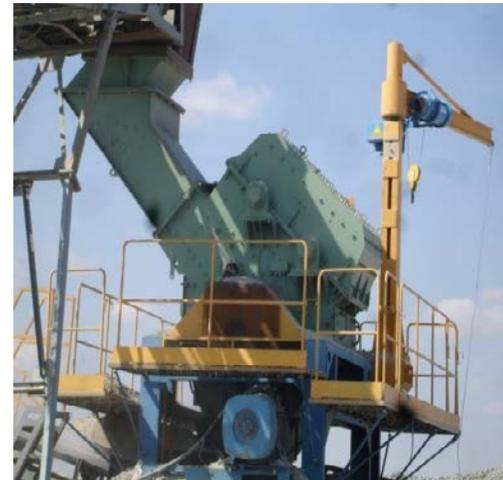
Дробилка ДИМ 800К имеет рамную металлоконструкцию с удобными площадками обслуживания.
