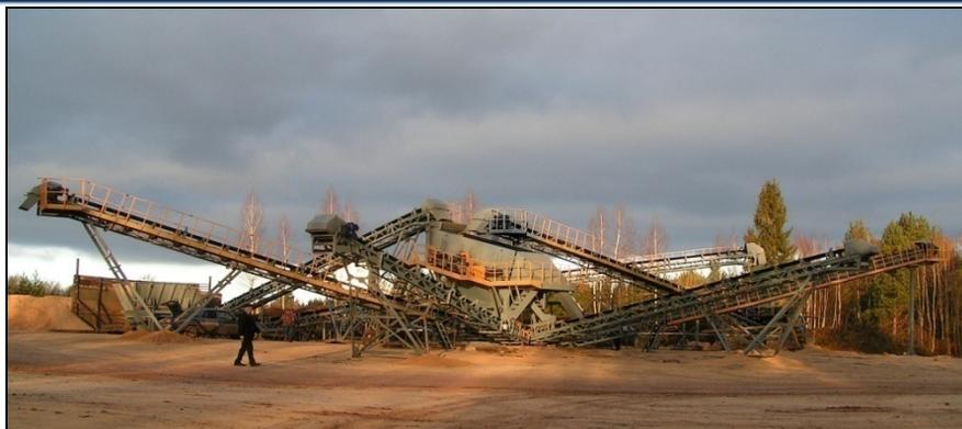
Высокопроизводительные дробильно-сортировочные комплексы имеют блочный метод построения на основе агрегатов различной функциональности. Эффективно решают задачи переработки породы любой прочности в кубовидный щебень, крошку, песок, а также могут быть настроены на получение продукта минимальной крупности, так называемого «грубого» помола.
