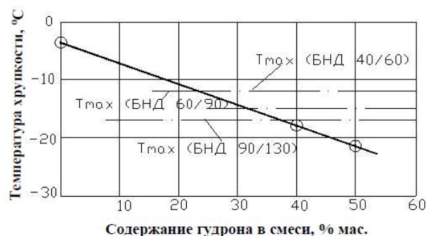
Рис. 2. Изменение растяжимости и температуры хрупкости вторичного битума в зависимости от степени разбавления гудроном
