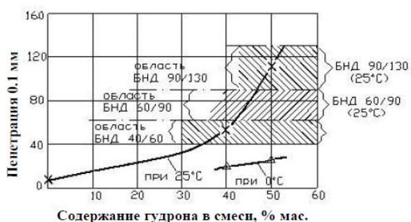
Рис. 1. Изменение показателей вязкости вторичного битума в зависимости от степени разбавления гудроном
